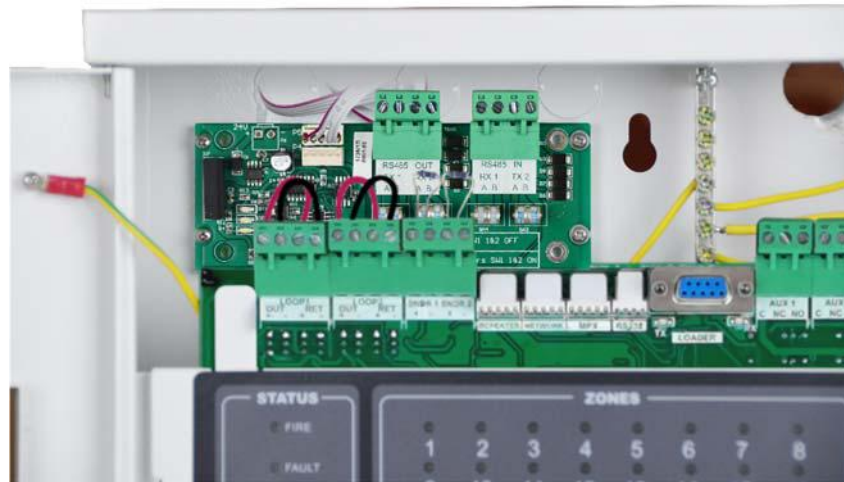
Fig. 10 – 6001-03 Tarjeta interfaz de red para conexión de paneles repetidores
