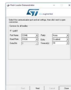
Figura 40 – Configuración del puerto COM
