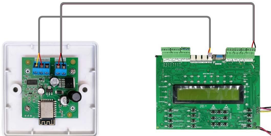
Fig. 36 – Módulo Wi-Fi - Conexiones de alimentación y datos
